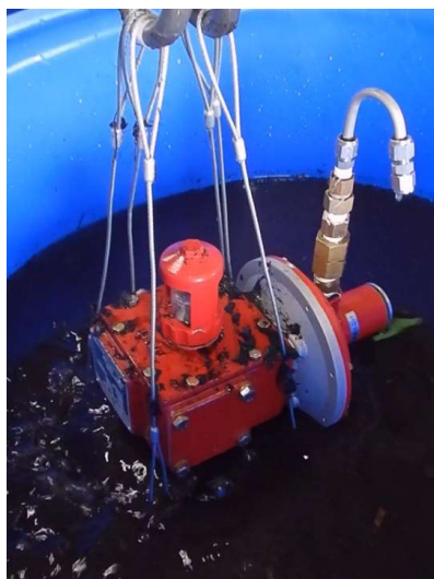
写真2 汚水による浸感弁の浸水実験
